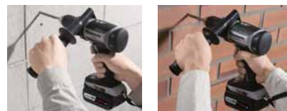
コンクリートブロック 穴あけ
