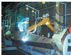
V型50度開先、多層盛3パス溶接
